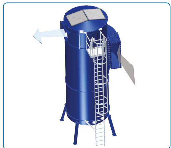
BF-Filter mit Kratzboden und tangentialem Eintritt. Abgebildet mit VFV®-Explosionsentlastung im Filterkopf. Mit Leiter und Plattform montiert.
